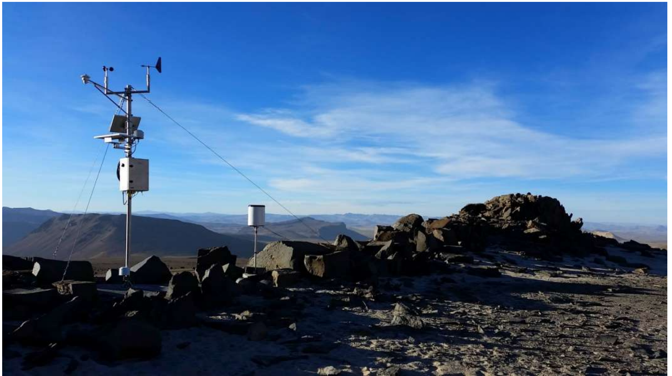
Nejvýše položená klimatická stanice v Latinské Americe (5 280 m n.m.), satelitní přenos dat, česká firma Fiedler, bezporuchový provoz od 2016/11
